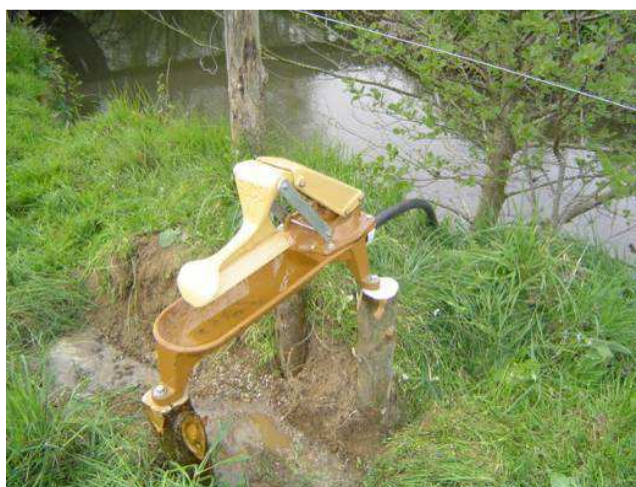
Installation avec vissage sur 3 piquets en châtaignier
